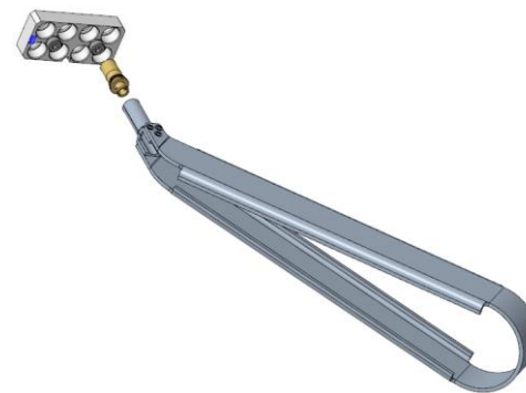
图 5 专用装入工具 QX-RF-12 的使用方法
